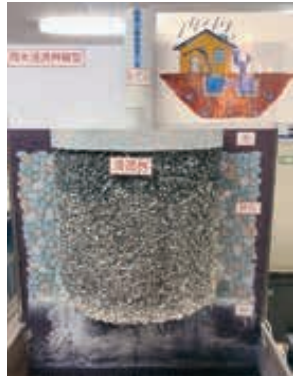
雨水浸透ます
